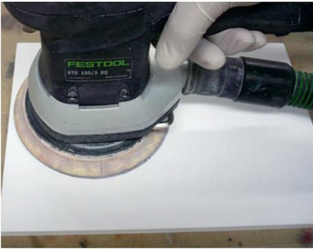
**2/** Nachdem die Fläche über Nacht bei Raumtemperatur getrocknet ist, wird sie mit Korn 320 geschliffen. Direkt nach dem Schleifen kann mit dem nächsten Schritt begonnen werden.
