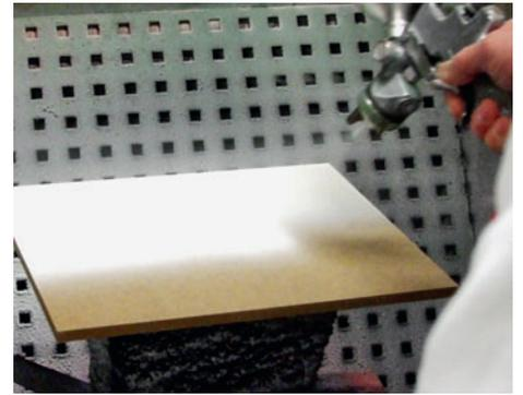
**1/** Zunächst wird die zu lackierende Fläche mit Korn 120 angeschliffen, um eine optimale Haftung zu erzielen. Anschließend wird die Fläche mit dem wasserbasierten 1K Aqua-Unifiller 433 grundiert, um für eine gleichmäßige, glatte Oberfläche zu sorgen.
